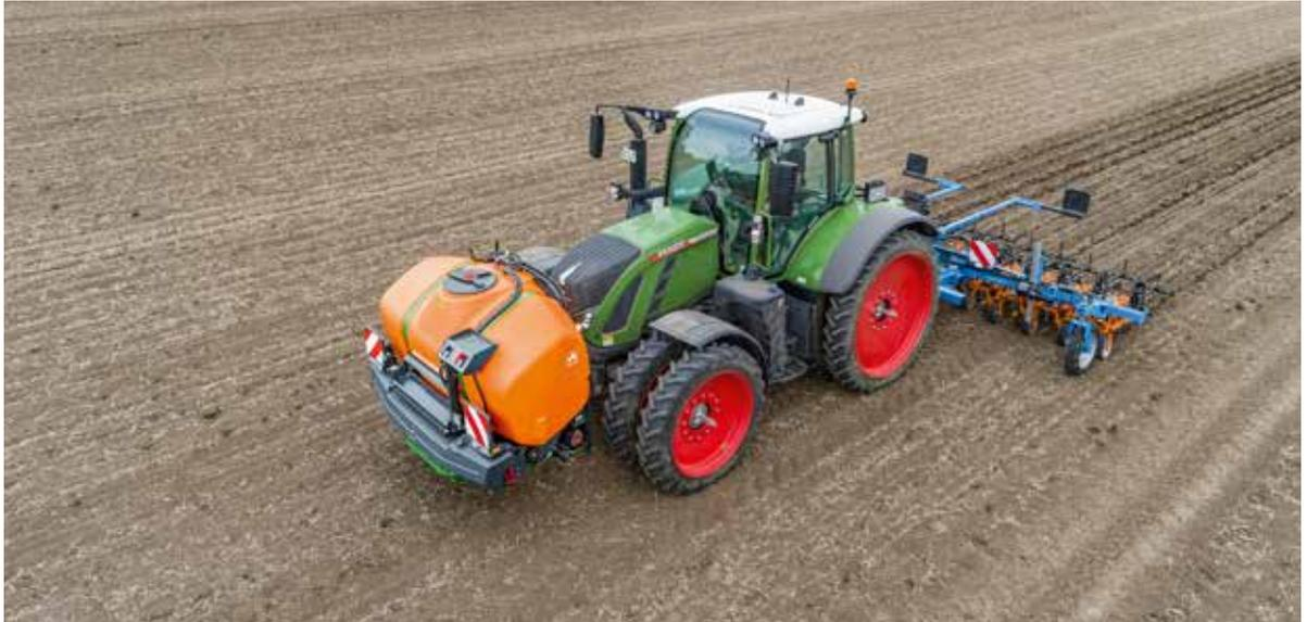
Der Fronttank FT-P 1502 im Einsatz mit einer SCHMOTZER Hackmaschine für die Bandspritzung
