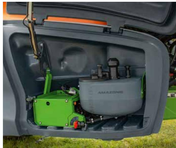
**DirectInject-Ausstattung mit 50-l-Tank und Pumpeneinheit im Ablagefach der UX 01 Super**
