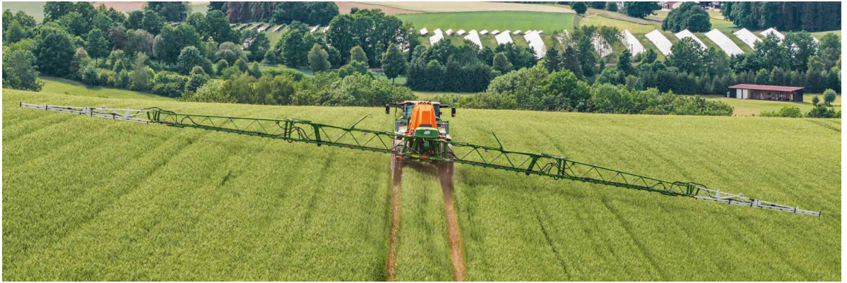
Automatischer Hangausgleich für mehr Komfort und Sicherheit.
