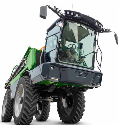
Bis zu 2,05 m hohe Räder, Bodenfreiheit bis 1,30 m
