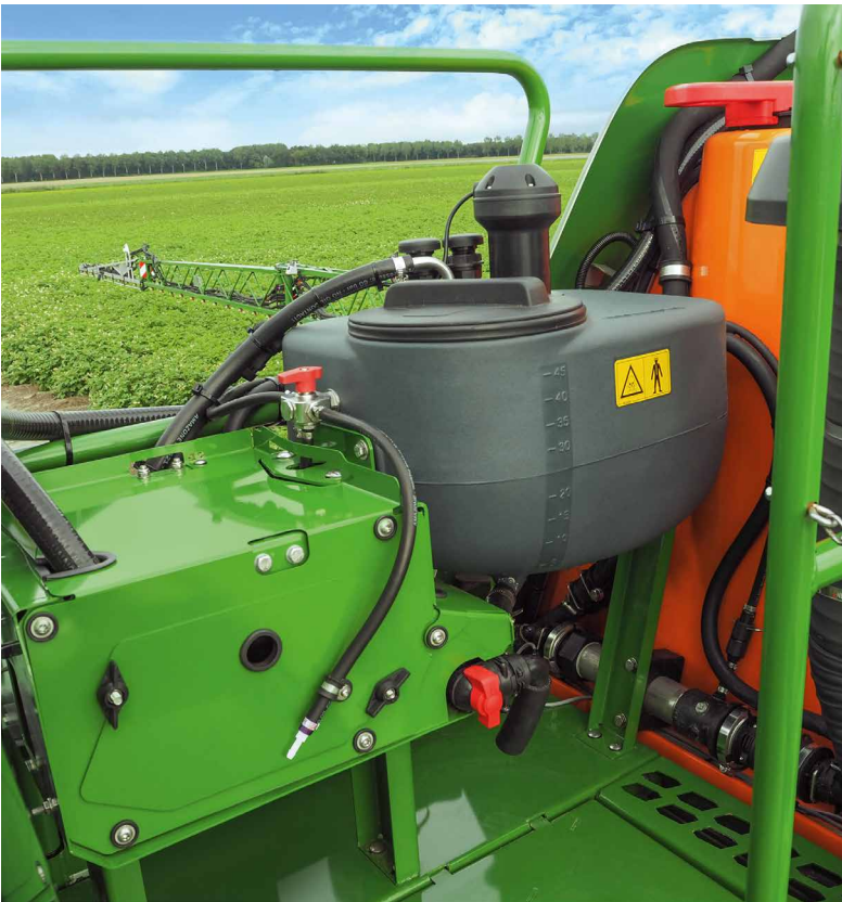
DirectInject auf der Pantera zwischen Kabine und Spritzflüssigkeitstank.
