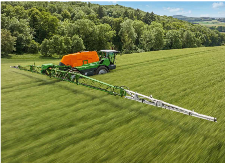
Pantera 7004 mit 36 m breitem Super-L3-Gestänge.
