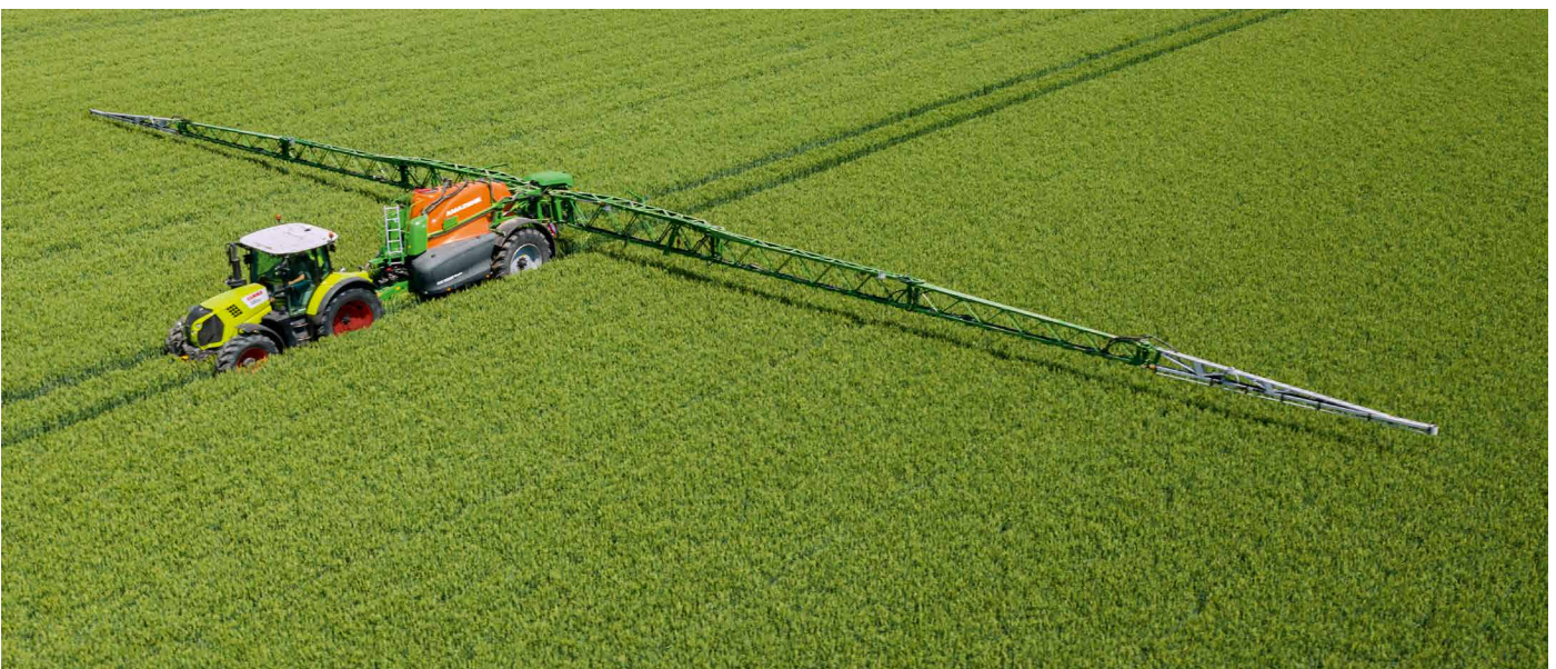
Die Super-L3-Gestänge mit bis zu 48 m Arbeitsbreite sind sowohl für die gezogenen als auch selbstfahrenden Pflanzenschutzspritzen verfügbar.
