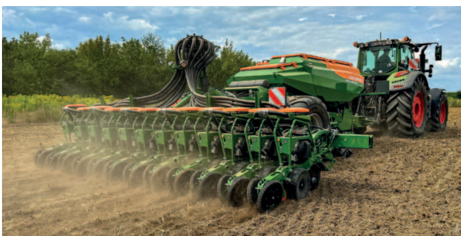
Für die Rapsaussaat hatten wir die Precea 6000 TCC mit dem zentralen Saatguttanksystem zur Verfügung. Außerdem besaß jede Reihe den zusätzlichen 8 l großen Behälter.
