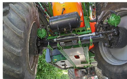
Mit 2,25 m Spur sind auch mit Rädern der Größe 520/85 R 42 noch 26° Lenkeinschlag möglich. Die Bodenfreiheit beträgt 80 cm.
