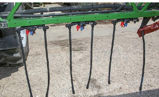
Die Düsenräger mit „Verlagerungssatz“ für 25 cm Düsenabstand sind einzeln geschaltet und ermöglichen die Schleppschlauchmontage.
