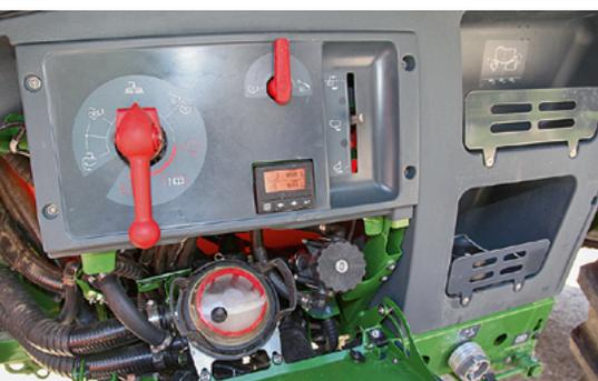
Beim Comfort-Paket gibt es einen elektrischen Saughahn mit Display, der Mehrwegehahn auf der Druckseite ist dagegen manuell bedient.
