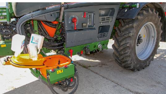
Die Einspülschleuse hat eine gewaltige Saugleistung und mit Doppelpumpe samt Injektor beträgt die Befüll-Leistung stolze 705 l/min.
