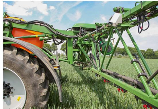
*Die neue Gestängeführung „ContourControl“ arbeitet mit einem zentralen Hydraulikzylinder, der aktiv Schwingungen entgegenwirkt.*
